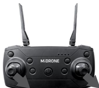
Veuillez effectuer cet étalonnage si le drone vole de manière instable. Cette fonction effectue une réinitialisation du gyroscope du drone et des réglages fins (TRIM). Avant l'étalonnage, il est nécessaire de placer le drone sur une surface plane. Appuyez sur les deux joysticks comme indiqué sur l'image de gauche. Après 2 secondes les lumières du drone clignoteront rapidement. L'étalonnage est maintenant terminé.
