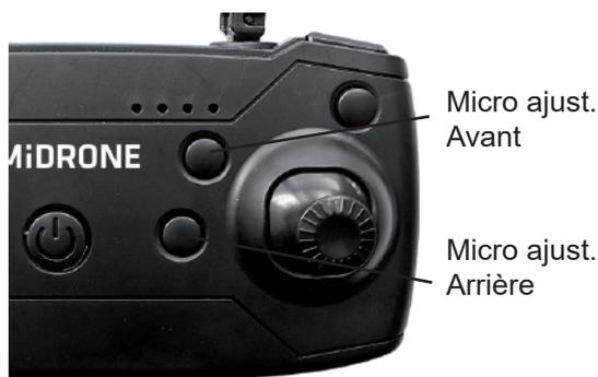
Si le drone dérive vers l'arrière en vol stationnaire, appuyez sur le bouton «Micro ajustement avant» pour le corriger, jusqu'à ce que le drone ne dérive plus.
