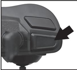
Le bouton vitesse contrôle la vitesse de vol en avant, arrière, gauche et droite. Le réglage par défaut est la vitesse basse. Appuyez sur ce bouton, la télécommande émettra deux bips sonores, le mode vitesse moyenne est sélectionné. Appuyez à nouveau sur ce bouton, la télécommande émettra trois bips sonore, le mode haute vitesse est sélectionné. Appuyez encore une fois sur ce bouton et le drone reviendra en mode vitesse basse (1 bip sonore).
