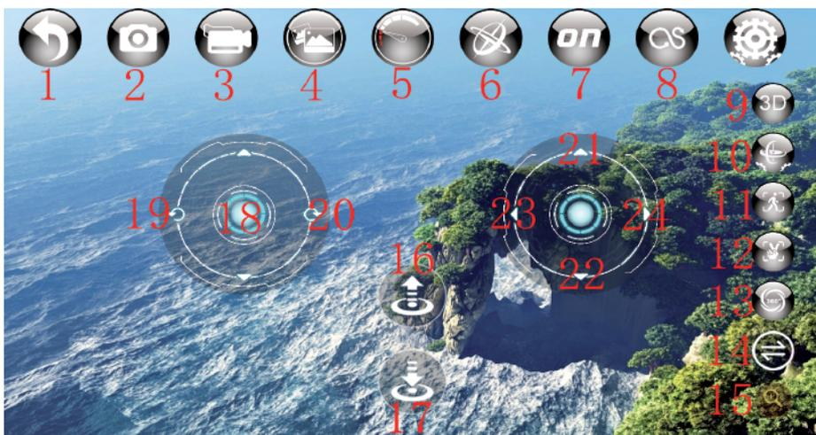
Activer le contrôle par inclinaison sur l'interface de contrôle (icône 6 dans le descriptif de l'interface de contrôle ci-dessus). Lorsque ce mode est activé, la manette de droite passe automatiquement en contrôle par inclinaison du smartphone. Les contrôles de la manette de gauche restent actifs pour la gestion de l'altitude et de la rotation.
