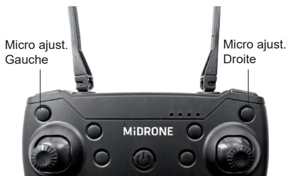
Si le drone dérive vers la droite en vol stationnaire, appuyez sur le bouton «Micro ajustement gauche» pour le corriger, jusqu'à ce que le drone ne dérive plus.
