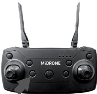
En cas d'urgence, un arrêt direct des moteurs est possible en faisant une pression longue sur le bouton «Auto atterrissage» de la télécommande comme montré sur l'image à gauche.
