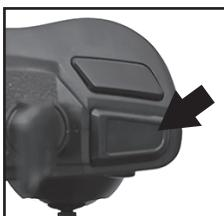
El modo de alta / baja velocidad controla la velocidad del vuelo hacia adelante / atrás / izquierda / derecha. La configuración predeterminada es el modo lento. Presione el botón «velocidad», el control remoto emitirá dos pitidos y se seleccionará el modo de alta velocidad. Presione nuevamente, este botón, el control remoto emitirá un pitido y el dron volverá al modo de velocidad lenta.
