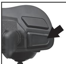
Der Hoch / Niedrig-Geschwindigkeitsmodus steuert die Geschwindigkeit des Vorwärts- / Rückwärts- / Links- / Rechtsfliegens. Die Standardeinstellung ist der langsame Modus. Drücken Sie die Taste «speed». Die Fernbedienung gibt zwei Pieptöne aus. Der Hochgeschwindigkeitsmodus ist ausgewählt. Wenn Sie diese Taste erneut drücken, gibt die Fernbedienung einen Piepton aus und die Drohne kehrt in den langsamen Geschwindigkeitsmodus zurück.
