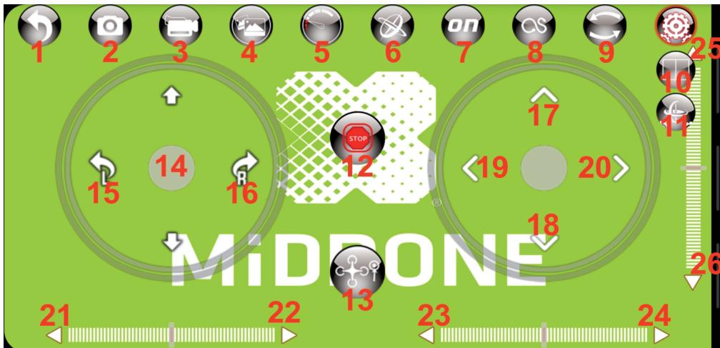
Aktivieren Sie die G-Sensor-Steuerung im Steuermenü (Symbol 6 in der Beschreibung des Steuermenüs in der Abbildung links).
