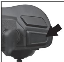
De modus Hoge / Lage snelheid regelt de snelheid waarmee naar voren / achteren / links / rechts wordt gevlogen. De standaardinstelling is de langzame modus. Druk op de knop "speed", de afstandsbediening zal twee "piep"-geluiden produceren, de hogesnelheidsmodus is geselecteerd. Druk nogmaals op deze knop, de afstandsbediening zal één "piep"-geluid geven en de drone keert terug naar de langzame-snelheidsmodus.
