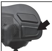
Le mode haute / basse vitesse contrôle la vitesse de vol en avant, arrière, gauche et droite. Le réglage par défaut est la vitesse basse. Appuyez sur le bouton «Sélection de vitesse», la télécommande émettra deux bips sonores, le mode grande vitesse est sélectionné. Appuyez à nouveau sur ce bouton, la télécommande émettra un «bip» et le drone reviendra en mode vitesse basse.
