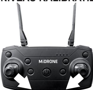
Voer deze kalibratie uit als de drone onstabiel vliegt. Deze functie maakt een reset van de gyro van de drone en van de fijne aanpassingen (TRIM). Vóór de kalibratie moet de drone op een vlak oppervlak worden geplaatst. (Als het landingsgestel niet recht is, wordt de reset-functie beïnvloed). Duw beide joysticks zoals getoond op de linker foto, na 2 seconden geeft de afstandsbediening een «piep» geluid en de lichten van de drone zullen snel zeven keer knipperen, de kalibratie is nu voltooid.
