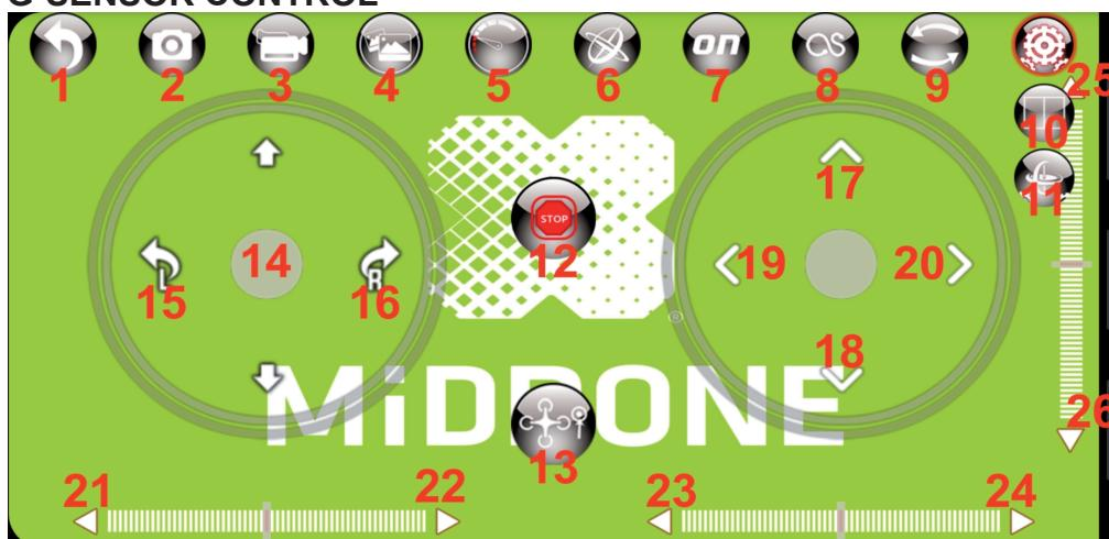
Habilite el control mediante el giroscopio en la interfaz de control (el ícono 6 en la descripción de la interfaz de control que aparece en la figura de la izquierda) Al habilitar este modo, el control ejercido con la palanca de mando derecha pasa a realizarse automáticamente mediante la inclinación del teléfono inteligente. Los controles que se realizan con la palanca de mando izquierda permanecen activos para gestionar la altitud y el giro.
