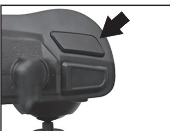
En cas d'urgence, un arrêt direct est possible en appuyant longuement (plus de 2 secondes) sur le bouton 3D Flip. (Voir image à gauche) N'utilisez pas cette fonction lorsque le drone vole normalement à haute altitude, sinon l'appareil tomberait directement et serait endommagé ou pourrait causer des dommages ou des blessures.
