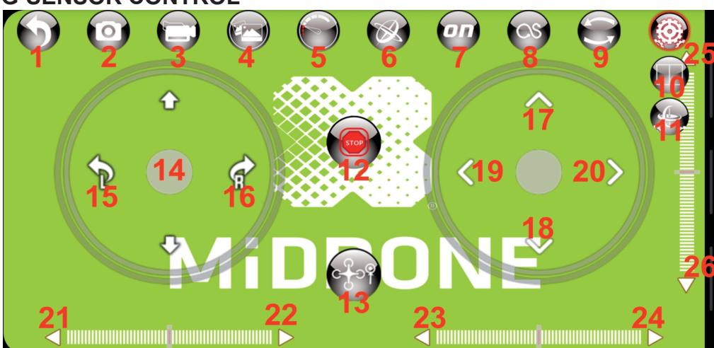
Inschakelen G-sensor controle op de bedieningsinterface (icoon 6 in op de foto hierboven)
