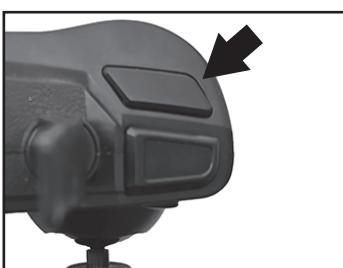
In geval van nood is een dringende uitschakeling mogelijk door de 3D Flip-knop diep in te drukken (meer dan 2 seconden). (zie afbeelding links) Gebruik deze functie niet als de drone normaal op hoog niveau vliegt of de drone zal direct naar beneden vallen en beschadigd geraken.
