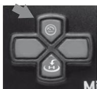
Le mode haute / basse vitesse contrôle la vitesse de vol en avant, arrière, gauche et droite. Le réglage par défaut est la vitesse basse. Appuyez sur le bouton «Sélection de vitesse», la télécommande émettra deux bips sonores, le mode grande vitesse est sélectionné. Appuyez à nouveau sur ce bouton, la télécommande émettra un «bip» et le drone reviendra en mode vitesse basse.
