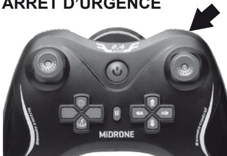
En cas d'urgence, un arrêt direct est possible en appuyant longuement (plus de 2 secondes) sur le bouton 3D Flip. (Voir image à gauche) N'utilisez pas cette fonction lorsque le drone vole normalement à haute altitude, sinon l'appareil tomberait directement et serait endommagé ou pourrait causer des dommages ou des blessures.
