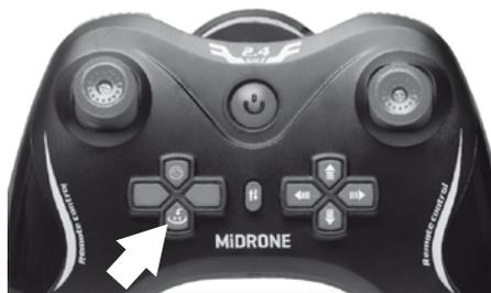
Lorsque vous appuyez sur ce bouton, le drone revient automatiquement vers l'emplacement de la télécommande et cette fonction s'arrête lorsque vous utilisez le joystick de droite pour contrôler la direction du drone.
