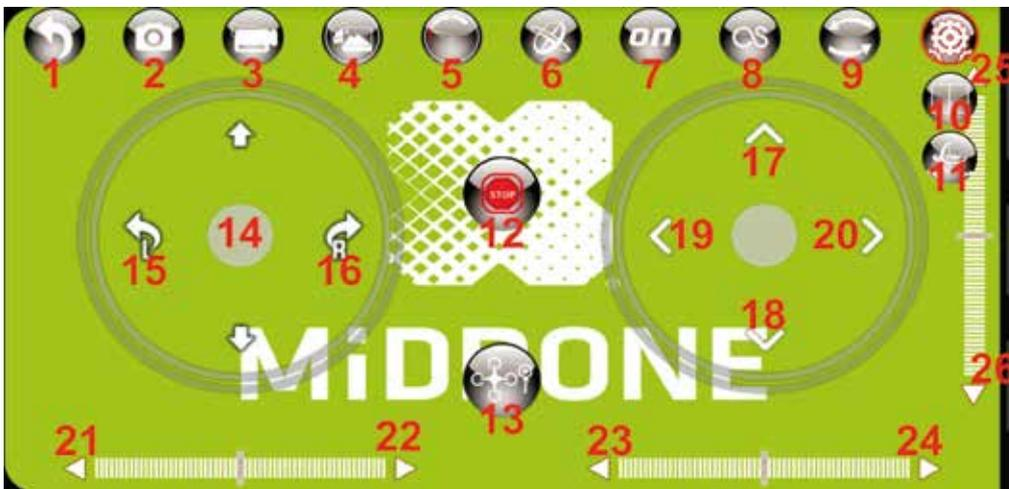
Activer le contrôle par inclinaison sur l'interface de contrôle (icône 6 dans le descriptif de l'interface de contrôle ci-dessus). Lorsque ce mode est activé, la manette de droite passe automatiquement en contrôle par inclinaison du smartphone. Les contrôles de la manette de gauche restent actifs pour la gestion de l'altitude et de la rotation.
