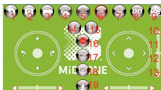
Activer le contrôle par inclinaison sur l'interface de contrôle (icône 7 dans le descriptif de l'interface de contrôle ci-contre).
