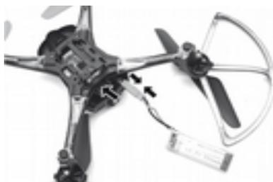
Installer la batterie complètement chargée dans l'emplacement prévu à cet effet en-dessous du drone et brancher le câble dans la fiche d'alimentation du drone comme illustré sur l'image de gauche.
