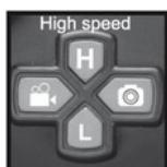
Los botones H y L se utilizan para cambiar la velocidad de vuelo hacia adelante / atrás / hacia la izquierda / hacia la derecha del dron. La configuración por defecto cuando el control remoto se apaga es a baja velocidad.
