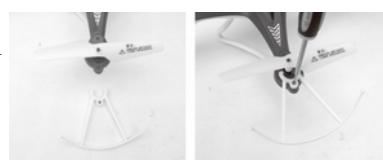
Si un reemplazo de la hélice es necesario prestar especial atención a la dirección de rotación. Más detalles en la ilustración de la derecha.
