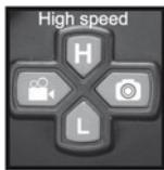
De H en L knoppen worden gebruikt om de vliegsnelheid vooruit / achteruit / naar links / naar rechts van de drone te veranderen. De standaardinstelling wanneer de afstandsbediening wordt uitgeschakeld is op lage snelheid. Druk op H-toets, de afstandsbediening laat twee pieptonen horen om te waarschuwen dat de hoge snelheid is geactiveerd. Druk op L-toets, de afstandsbediening laat twee pieptonen horen om te waarschuwen dat de lage snelheid is geactiveerd.
