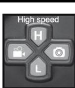
Les boutons H et L permettent de modifier la vitesse de vol avant / arrière / gauche / droite du drone. Le paramètre par défaut quand la télécommande a été éteinte est sur vitesse lente. Presser le bouton H, la télécommande émet 2 bips pour prévenir que le mode vitesse rapide est sélectionné. Presser le bouton L, la télécommande émet un bip pour prévenir que le mode vitesse lente est sélectionné.
