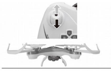
Avant chaque vol il faut établir la liaison entre le drone et la télécommande en réalisant cette manipulation : Pousser la manette de gauche totalement vers le haut et ensuite la tirer tout en bas. Un bip retentit quand la manette est en haut et un autre bip quand elle est bas. Les 2 bips indiquent que la synchronisation est réussie et que le drone est prêt à voler.
