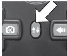
2. Une fois cette étape réalisée et que le drone est en vol, presser le bouton de changement de mode sur la télécommande pour activer le mode CF / Direction Lock. La télécommande émet un signal sonore (2 bips) et les LED du drone clignotent rapidement pour confirmer que ce mode est enclenché.
