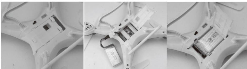
Introduzca la batería totalmente cargada en el compartimento correspondiente de la parte inferior del dron y enchufe el cable al conector de alimentación del dron, tal como se muestra en la imagen de la izquierda.
