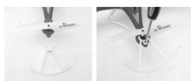
Bei einem notwendigen Austausch der Propeller bitte die Rotationsrichtungen beachten. Nähere Erläuterungen dazu sind im Bild rechts zu sehen.
