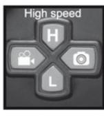
Zorg ervoor dat er een micro-SD-kaart in de camera is geplaatst voordat u foto's of video's maakt. De kaart moet type SDHC zijn met max. 32GB en moet geformateerd zijn in het FAT32 bestandsformaat. Druk éénmaal op de knop Foto om een foto te maken. Druk éénmaal op de videoknop om video op te nemen. Druk nogmaals op dezelfde knop om de opname te stoppen.
