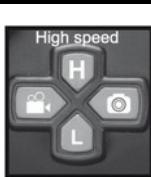
Assurez-vous qu'une carte micro SD est insérée dans l'emplacement de la caméra avant de prendre des photos et des vidéos. La carte doit être de type SDHC de max. 32GB et doit être formatée au format FAT32. Appuyez une fois sur le bouton Photo pour prendre une photo. Appuyez une fois sur le bouton vidéo pour commencer l'enregistrement de la vidéo. Appuyez à nouveau sur ce bouton pour arrêter l'enregistrement.
