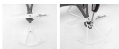
Si un remplacement d'hélice est nécessaire il faut faire particulièrement attention au sens de rotation. Plus de détails dans l'illustration à droite. Les hélices qui tournent dans le sens horaire sont marquées d'une lettre A. Celles qui tournent dans le sens anti-horaire sont marquées d'une lettre B.
