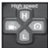
Die H- und L-Tasten werden verwendet, um die Fluggeschwindigkeit zu ändern, vorwärts / rückwärts / nach links / nach rechts von der Drohne. Die Standardeinstellung, wenn die Fernbedienung ausgeschaltet wird, ist auf langsamem.
