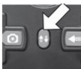
2. Wenn dieser Schritt abgeschlossen wurde und die Drohne fliegt, die Taste Headless-Modus auf der Fernbedienung drücken (siehe Beschreibung der Fernbedienung oben) um den CF-Modus / die Richtungssperre zu aktivieren. Die Fernbedienung piept (2
